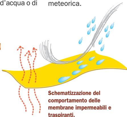
**Schematizzazione del comportamento delle membrane impermeabili e traspiranti.**
