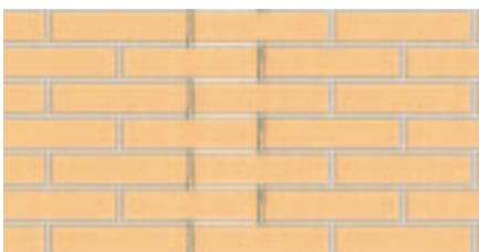
Se in fase di costruzione vengono collocate delle strisce rigide per contenere la malta (come nel caso dei giunti di dilatazione dentati), esse vanno rimosse prima di riempire il giunto, altrimenti verrà annullata l'utilità del giunto stesso.
